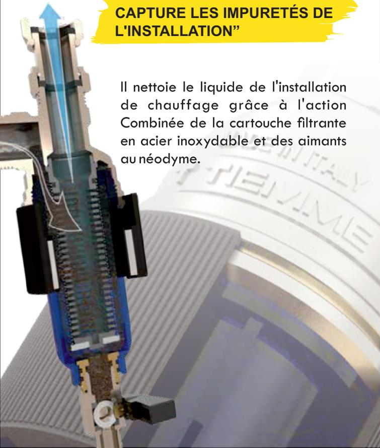
Les puissants aimants placés à l'intérieur de l'anneau extérieur créent un champ magnétique en mesure de bloquer les particules métalliques présentes dans le liquide. Le fluide passe ensuite à travers la maille filtrante en acier inoxydable; la maille bloque les résidus restants et fait en sorte qu'ils se déposent sur le fond du filtre, prêts à l'évacuation au moyen du robinet de vidange.
